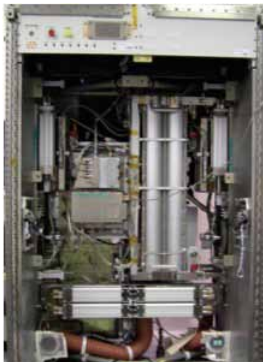
SLS kwalificatiemodel gemonteerd in NASA T2 Rack
