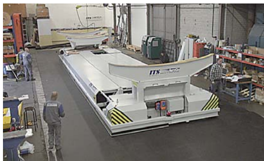
AeroGo leverde een 16-meter lange AGV op luchtkussens voor het dragen en bewegen van vliegtuigfuselages tot 40 ton tussen de verschillende werkstations.
