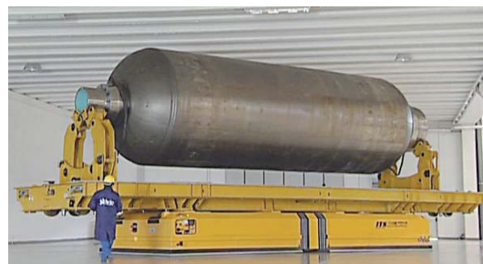
Een 130-Ton Aero-Pallet™ Transporteur van AeroGo verplaatst mals van brandstoftanks voor de Ariane raket en dit tussen de verschillende werkstations. De transporteur is uittrekbaar van 8,4 tot 12 meter.
