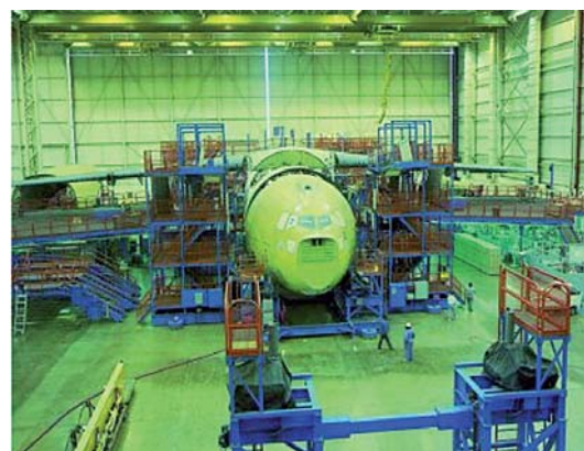
De mobiliteit van de reusachtige montage en het assemblageframe, staat de precieze constructie van het high-tech vliegtuig toe. Door middel van Aero-Casters® schuift het vliegtuig van 181 ton moeiteloos langs de productielijn tijdens de assemblage.
